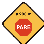
P33 (a) PROXIMIDAD DE SEÑAL RESTRICTIVA (pare)
