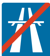
I.13 FIN DE AUTOPISTA
